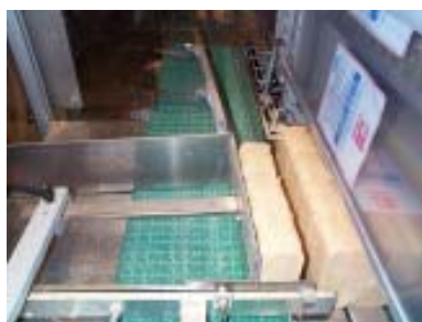
Briketterna orienteras framför påse i förpackningsmaskin och skjuts in.
