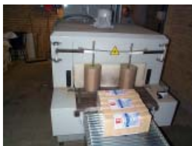
Påsen med briketter passerar krymptunnel och går vidare till rullband för vidare hantering
