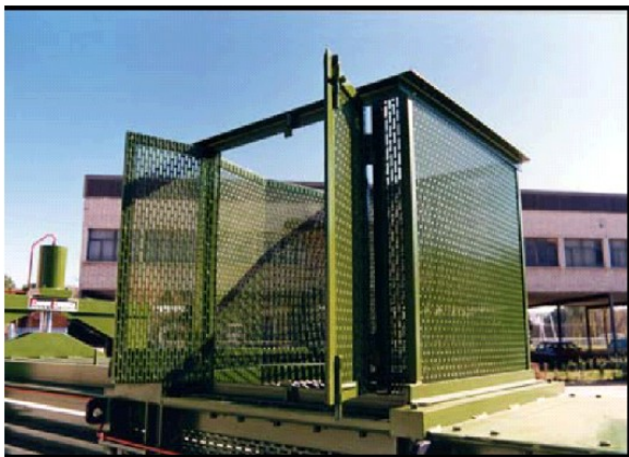
Inkast tratt perforerad för att kunna dränera vätska
