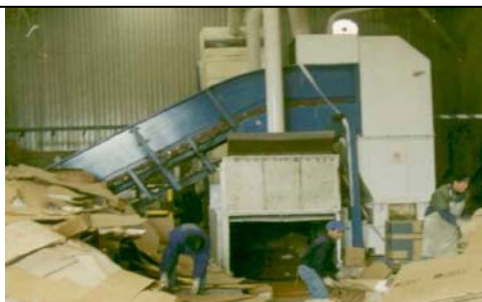
Anpassning med ventilations kåpor och inneslutning av balpressar för att undvika miljöfarlig damm till
