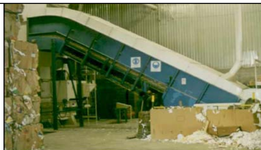
Anpassning med ventilations kåpor och inneslutning av balpressar för att undvika miljöfarlig damm till
