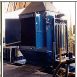
Anpassning med ventilations kåpor och inneslutning av balpressar för att undvika miljöfarlig damm till
